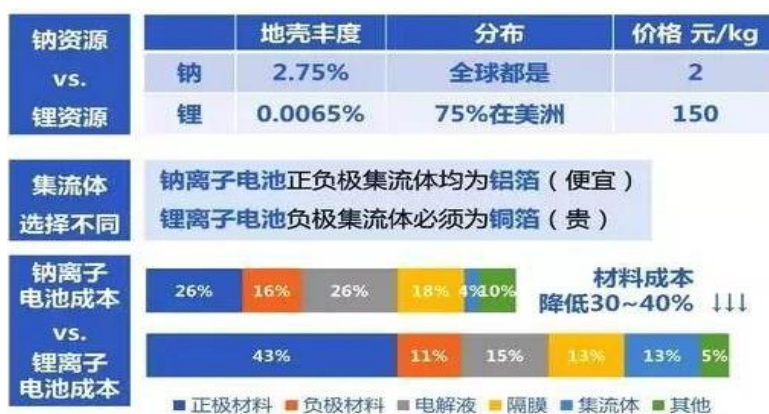
图 21 钠离子电池与锂离子电池材料组成及成本对比
